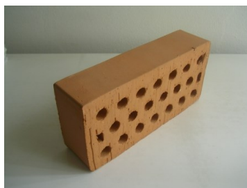
Figura 20.1 - Esempio di mattone pieno \phi \leq 15\% in laterizio per murature portanti 1
