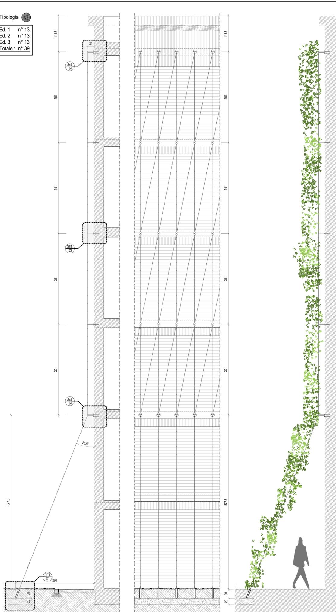
STRUTTURA PER PIANTE RAMPICANTI - Tipo V2 scala 1:50
