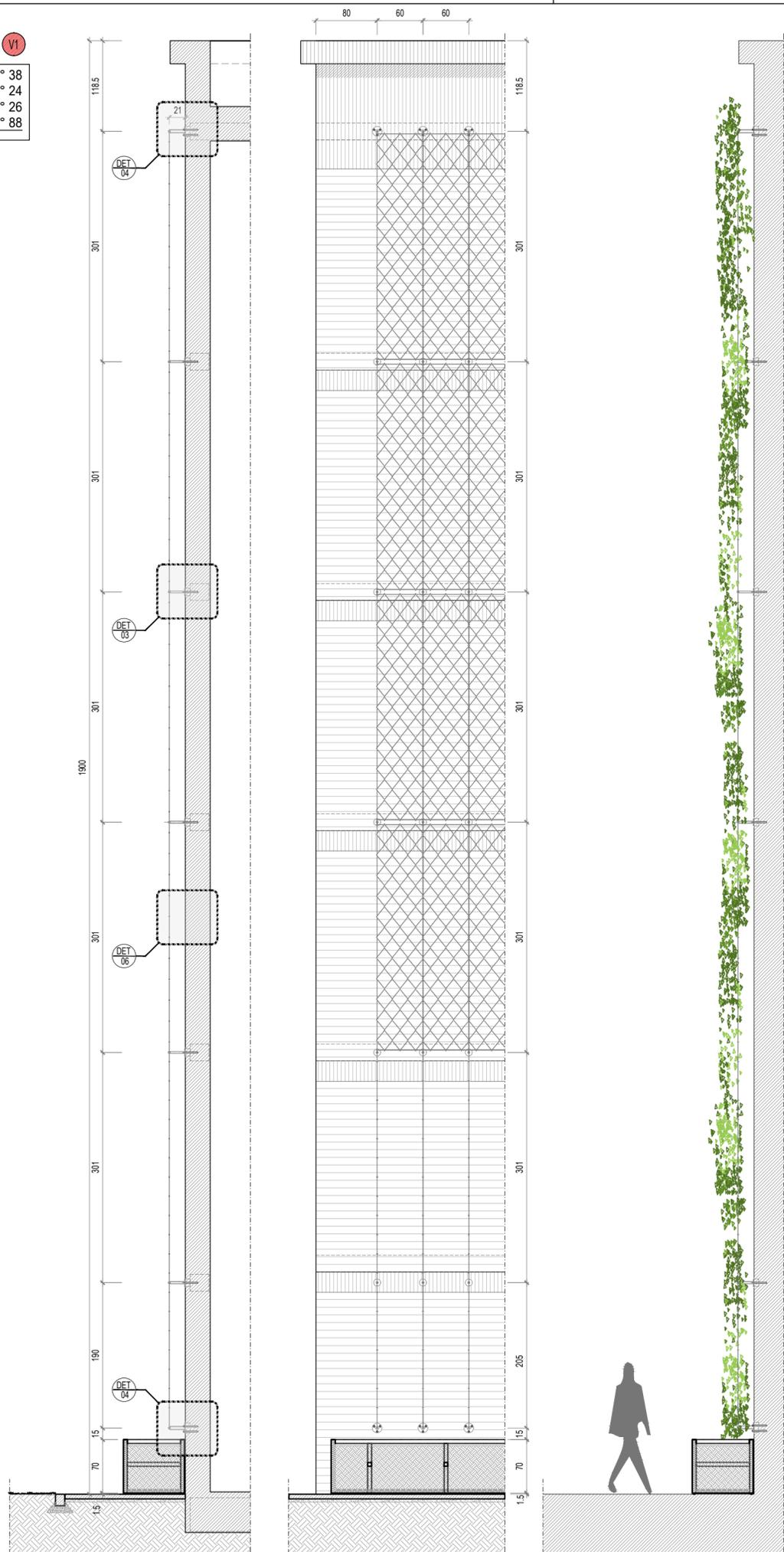
STRUTTURA PER PIANTE RAMPICANTI - Tipo V1 scala 1:50
