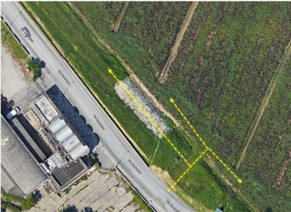
Figura 24 – Accesso dalla Via Montalese per la manutenzione di sinistra fossetta o per accedere allo sfioratore (in giallo i possibili percorsi di manutenzione)
