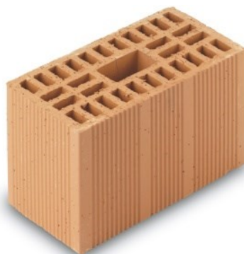
Figura 20.3 - Esempi di blocchi semipieni 15\% < \phi \leq 45\% in laterizio per murature portanti
