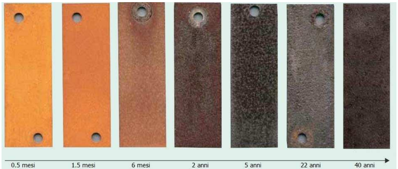
Figura 1 – Colore differente assunto dal COR-TEN in funzione del tempo di esposizione
