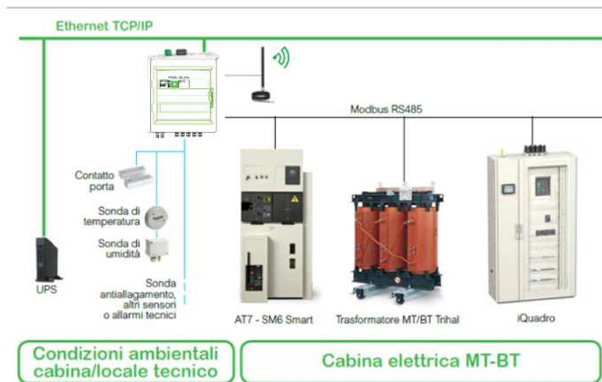
I componenti del quadro Energy box di componenti che consentono il collegamento via WEB e programmare pagine Web integrate e dedicate per la visualizzazione dei dati real-time e storici registrati nella memoria interna. La visualizzazione avviene sia in formato grafico che tabellare.
