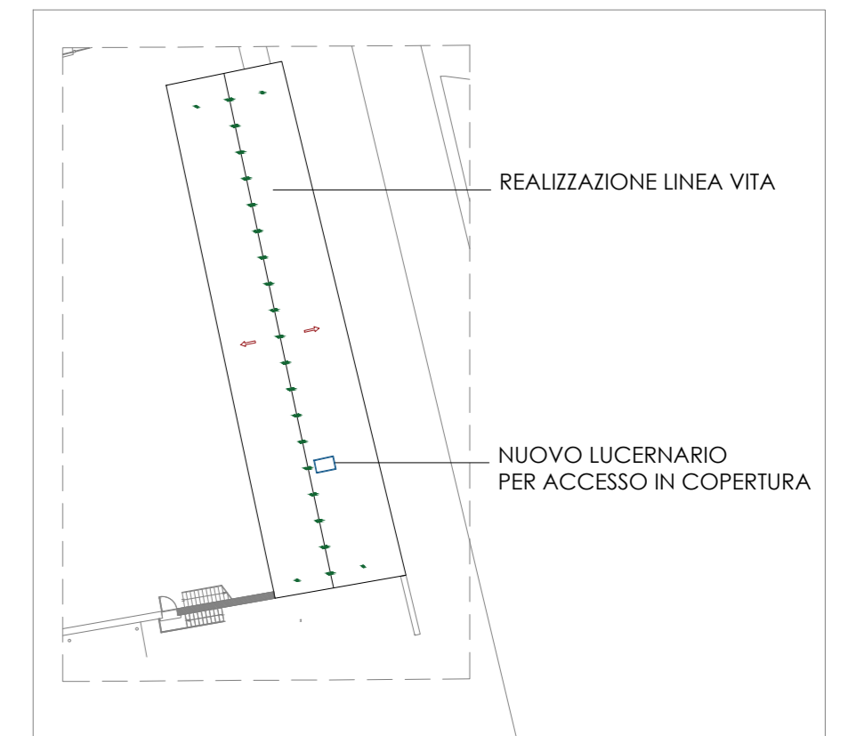
PIANTA COPERTURA SCALA 1:50 (VEDI EL.TECNICO COPERTURA)
