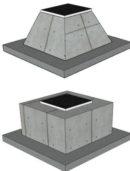
Il plinto prefabbricato viene realizzato in stabilimento attraverso casseforme reimpiegabili in acciaio.
