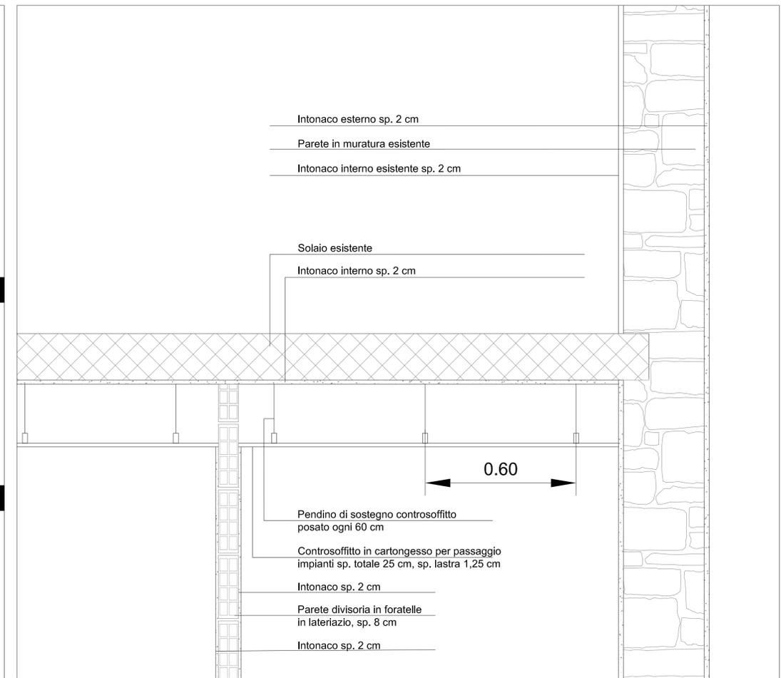
**\_dettaglio ancoraggio nuovo solaio si parete perimetrale - Scala 1:10**
