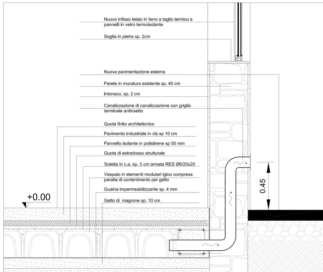
**\_dettaglio areazione del solaio di fondazione - Scala 1:10**
