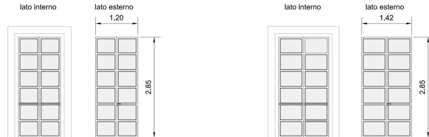
Infisso a doppia anta e vasistas con cremonese, costituita da telaio in ferro a taglio termico e pannelli in vetro termoisolante lastra esterna stratificata 33.2 composto da 3+3 pvb 0,76, intercapedine 16 mm con gas argon, lastra interna stratificata 33.2 composto da 3+3 pvb 0,76.
