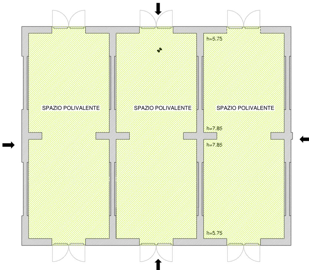
Fig. 2: Pianta dell’edificio con indicazione degli “ambienti abitativi” e delle pareti di facciata oggetto di verifica
