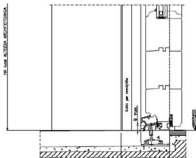
Figura 4 – Dettaglio della battuta inferiore dell'infisso (porta-finestra)
