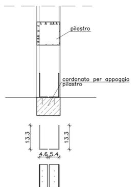
SEZIONE COMPLETA BASE PILASTRO SCALA 1:10
