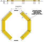
B) GAZEBO OTTAGONALE tipo LEGNOLANDIA La struttura comprende 16 montanti sezione 9x9cm in legno lamellare, pannelli di tamponamento con profilo fissato ad incastro sezione 7x7 cm, posizionati su 6 pareti e copertura in legno a 8 falde; manto di copertura in tegola canadese colore grigio-verde. Con pavimento e panchine laterali.
