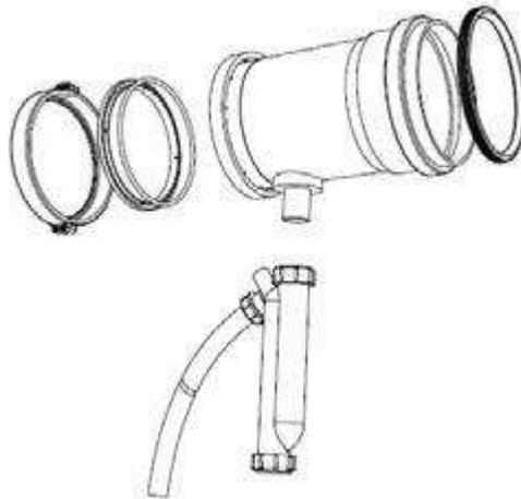
Dovrà essere installato un raccordo Y  $\varnothing 160/\varnothing 200$  codice Beretta 20132384 o equivalente
