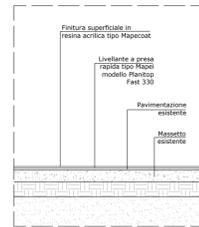
1) PAVIMENTAZIONE stratigrafia nuova pavimentazione in resina colorata sopra l'esistente Scala 1:20
