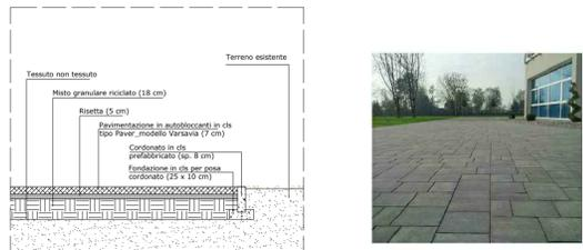
1) PAVIMENTAZIONE DRENANTE stratigrafia con nuova pavimentazione in autobloccanti in cls tipo Paver modello Varsavia
