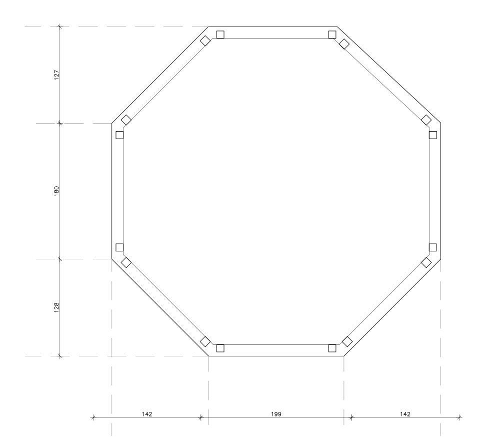
PLATEA SP 20CM C28/35 armatura inferiore r.e.s. diam 12mm maglia 20x20 armatura superiore r.e.s. diam 12mm maglia 20x20
