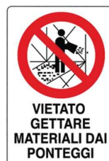
Vietato gettare materiali dai ponteggi
