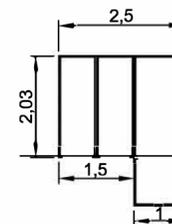
N1: infisso composto da : finestra a due ante con apertura a anta ribalta e una porta-finestra apribili , dotate tutte di chiave di chiusura
