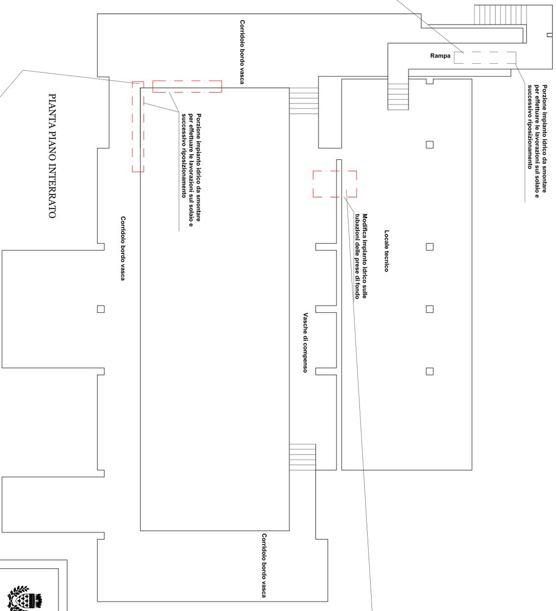
Porzione impianto idrico da smontare per effettuare le lavorazioni sul solaio e successivo riposizionamento
