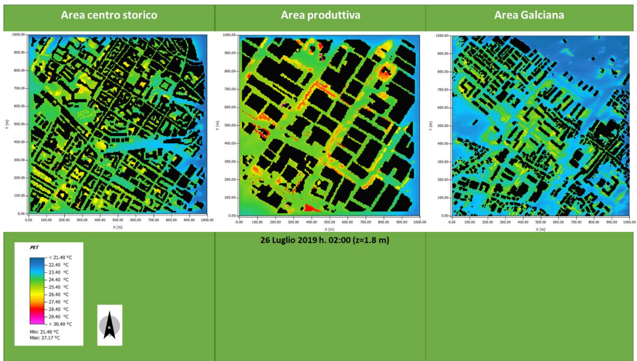
Figura 16. Temperatura fisiologica equivalente (PET) dell'aria a 1.8 m di altezza alle ore 02:00 simulata nelle tre aree inserite nel modello Envi-met.
