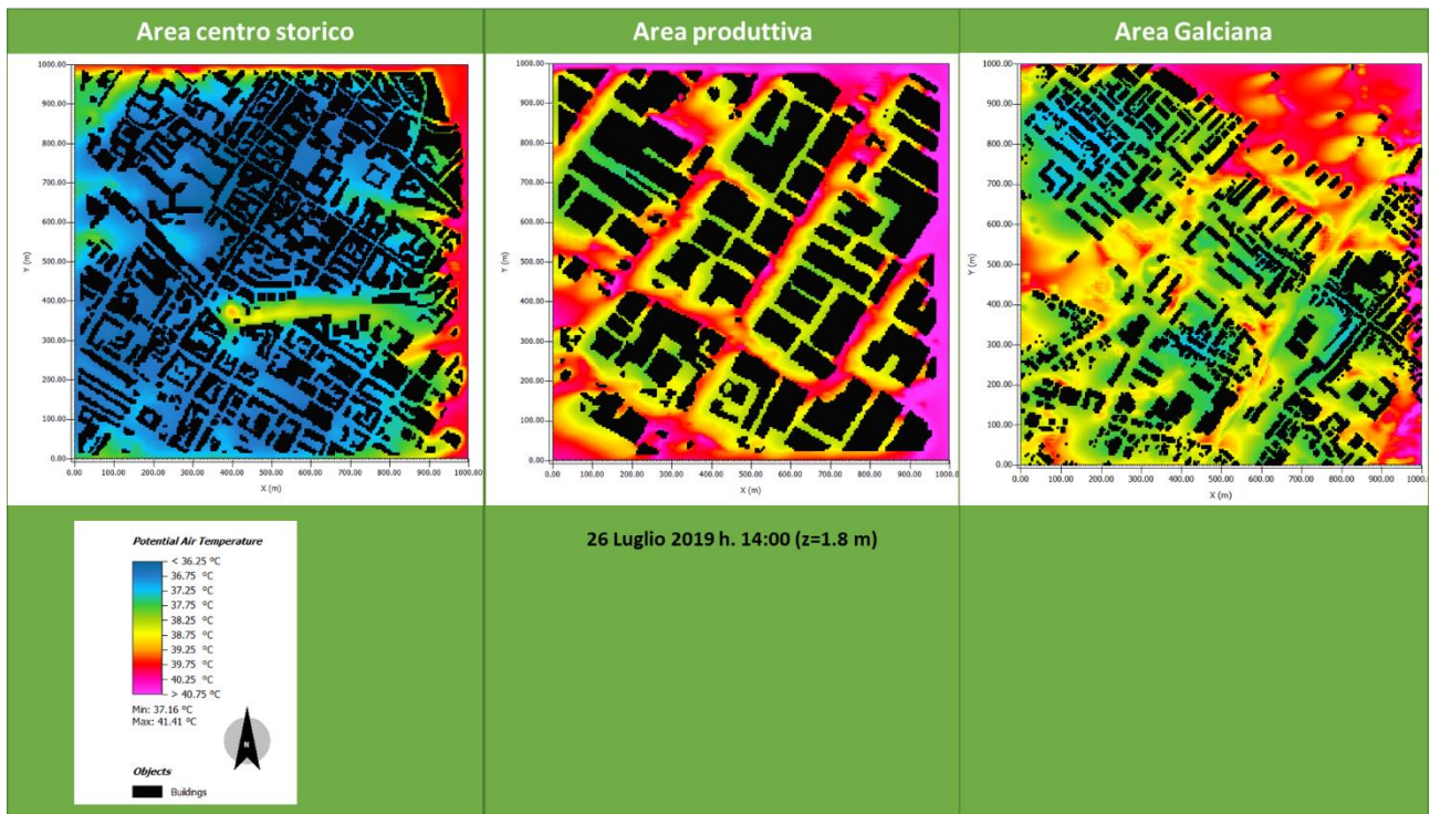
Figura 9. Temperatura dell'aria a 1.8 m di altezza alle ore 14 simulata nelle tre aree inserite nel modello Envi-met.
