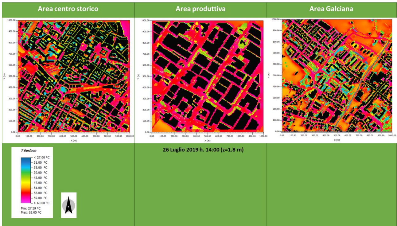
Figura 14. Temperatura superficiale alle ore 14:00 simulata nelle tre aree inserite nel modello Envi-met.
