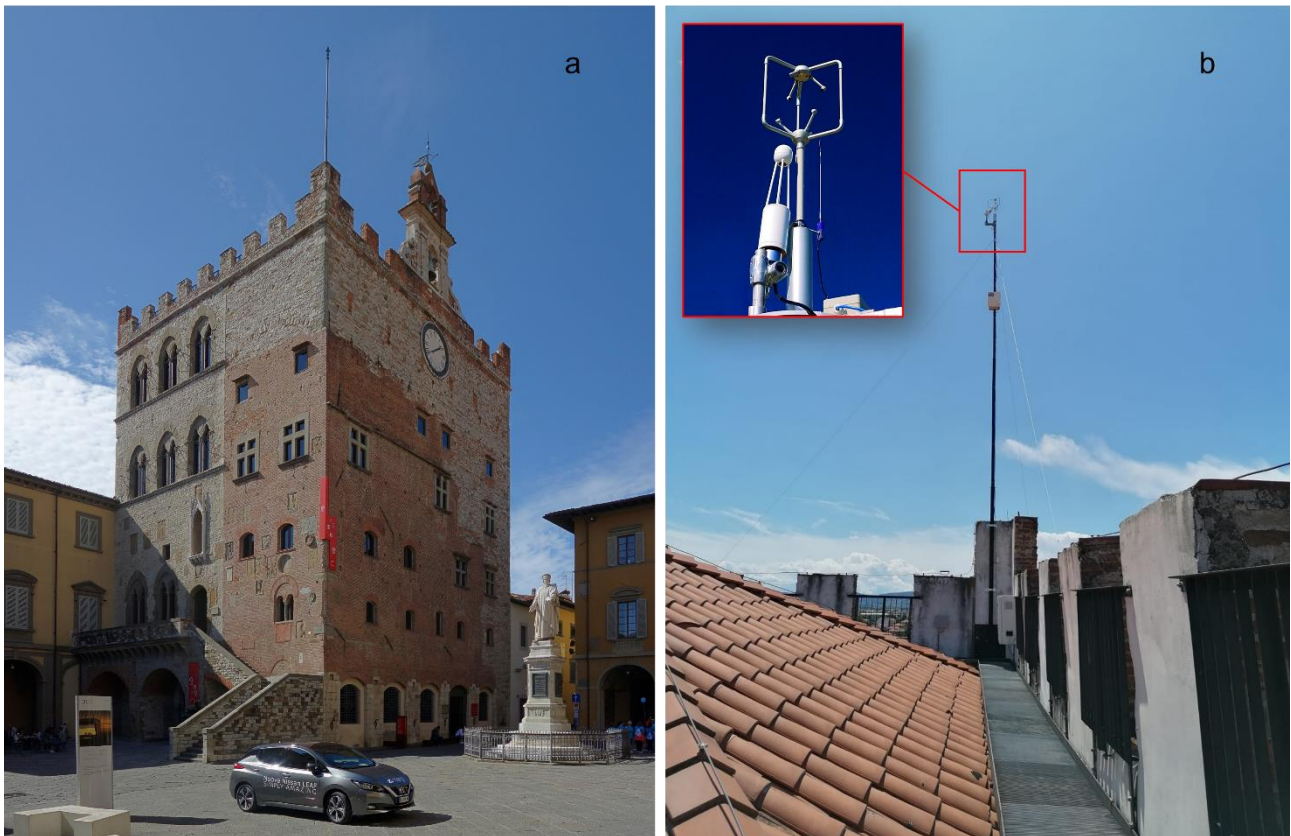
879 880 Figura 41. Installazione della stazione Eddy Covariance su Palazzo Pretorio (a) nel centro della città di Prato. A destra 881 (b) dettaglio della strumentazione utilizzata comprensiva di analizzatore di gas ad infrarosso e anemometro triassiale.
