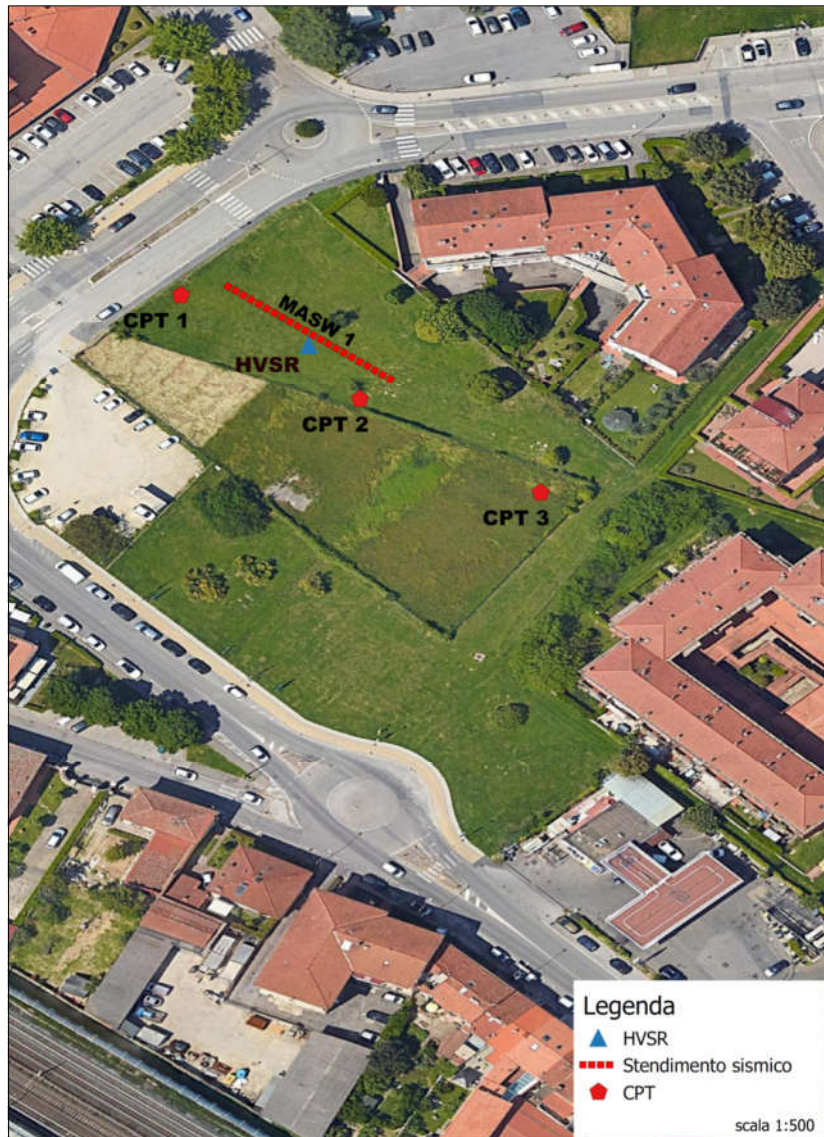
Figura 31 – Ubicazione indagini eseguite, Relazione Geologica di Fattibilità
