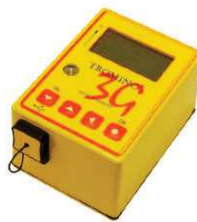
Figura 5. Tromografo utilizzato per l'indagine geofisica HVSR.
