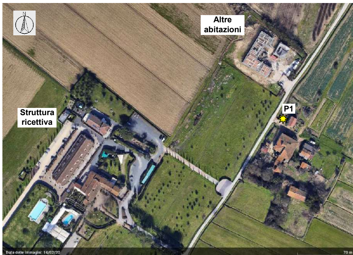
Figura 4: vista satellitare in pianta (fonte Google Earth) del sito con evidenziata la postazione di misura per clima acustico (P1 h.3,0m).
