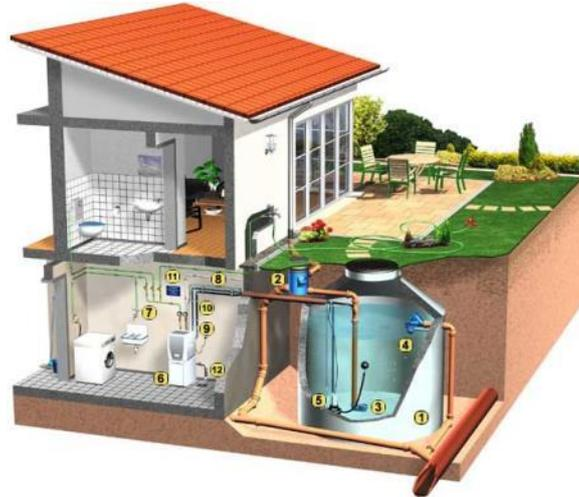
**Figura 54.** Esempio di recupero delle acque meteoriche dei tetti per usi interni all'abitazione, tramite l'utilizzo di un filtro (2) e di un serbatoio di stoccaggio (1) (Fonte: <http://www.3ptechnik.de>)
