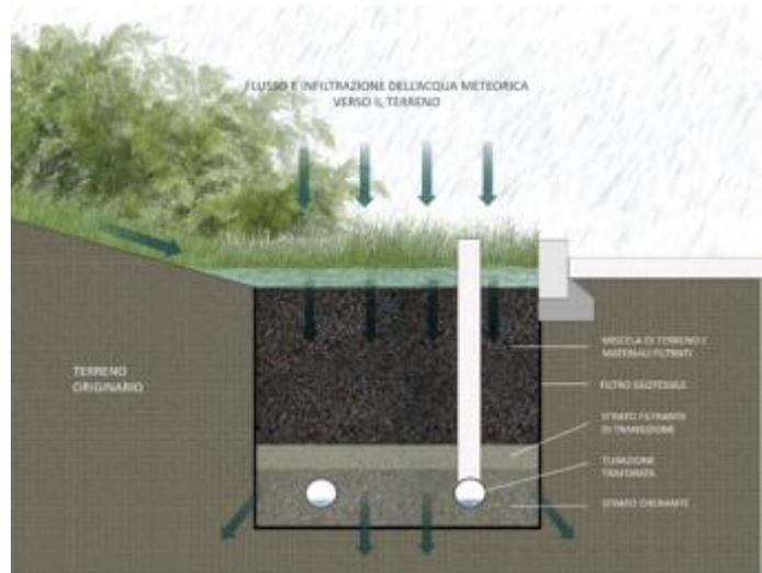
**Figura 38.** Sinistra: esempio area di bioritenzione (Woods Ballard et al. 2015. "The Suds Manual"). Destra: Tipologico area di bioritenzione (Linee guida sull'adozione di tecniche di drenaggio urbano sostenibile per una città più resiliente ai cambiamenti climatici del Comune di Bologna, 2018)
