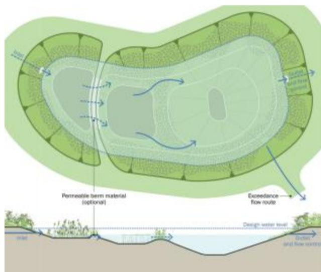
**Figura 45.** Sinistra: Esempio di stagno paesaggistico; Destra: Tipologico di stagno piantumato (Woods Ballard et al. 2015. "The Suds Manual")
