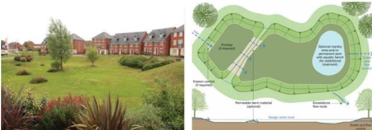
**Figura 43.** Sinistra: Esempio di bacino di detenzione vegetato; Destra: Tipologico di bacino di ritenzione vegetato (Woods Ballard et al. 2015. "The Suds Manual")
