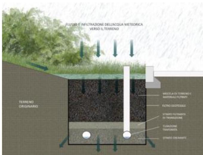
**Figura 20.** Sinistra: esempio area di bioritenzione (Woods Ballard et al. 2015. "The Suds Manual"). Destra: Tipologica area di bioritenzione (Linee guida sull'adozione di tecniche di drenaggio urbano sostenibile per una città più resiliente ai cambiamenti climatici del Comune di Bologna, 2018)
