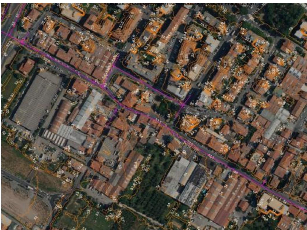
**Figura 51:** Tracciato planimetrico del rilievo fornito da Publiacqua del collettore di Via San Paolo e curve di livello di equidistanza 0.5 m estrapolate dal DTM1X1m della Regione Toscana
