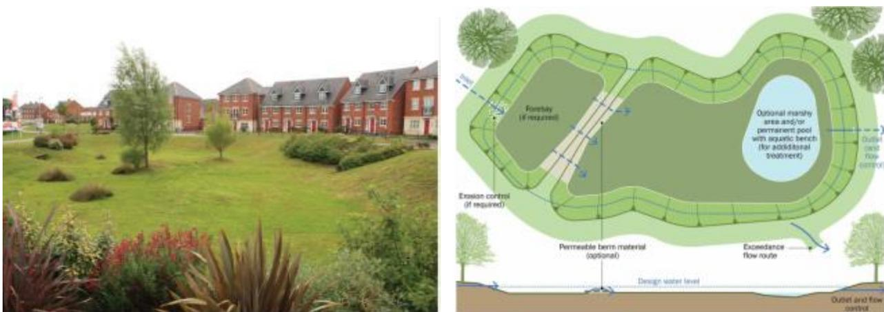
**Figura 22.** Sinistra: Esempio di bacino di ritenzione vegetato; Destra: Tipologico di bacino di ritenzione vegetato (Woods Ballard et al. 2015. "The Suds Manual")
