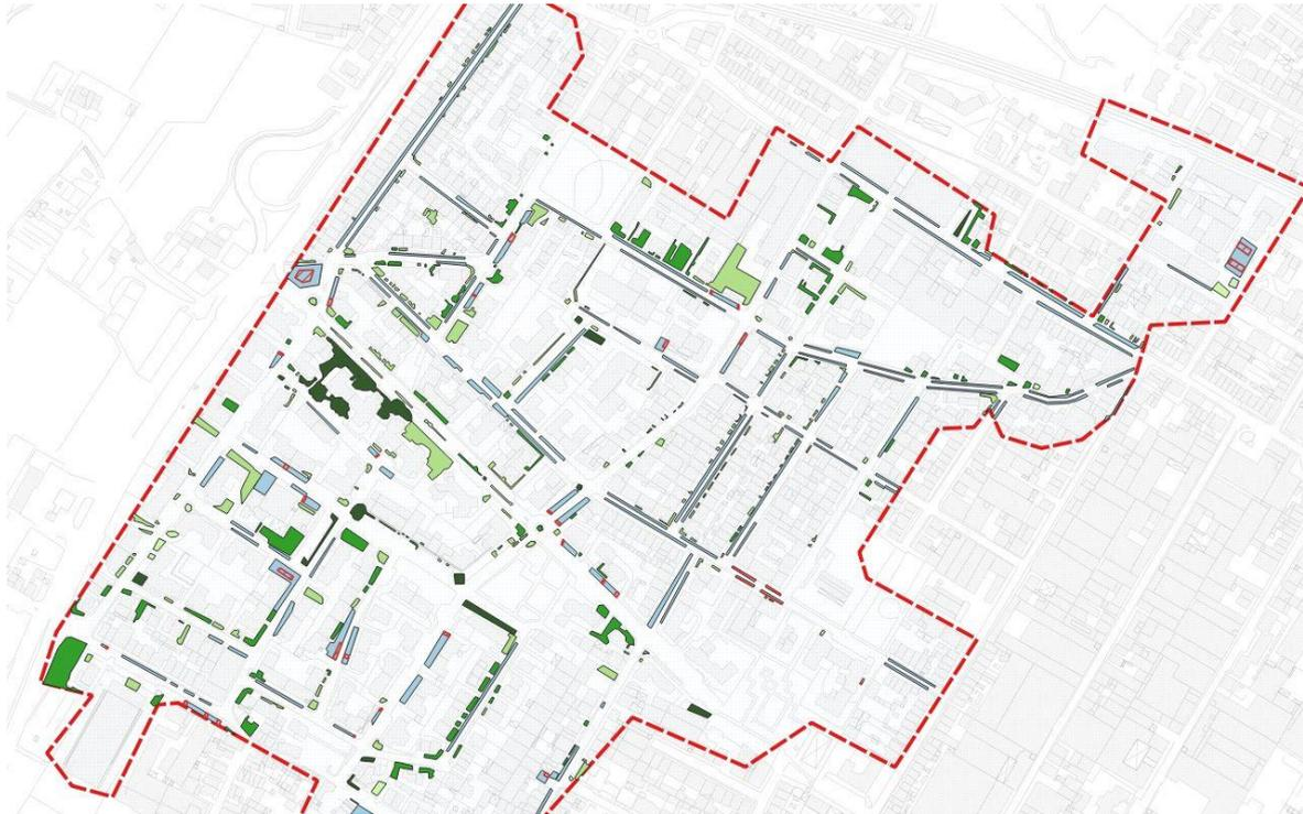
**Figura 59.** Alternativa 1, target evento con tempo di ritorno 10 anni (4058 mc). Occupazione area retrofitting SuDS, 4.2% del bacino drenato. N° interventi diffusi: 525. In azzurro in parcheggi interessati da interventi di retrofitting di tipo A. Quindi solo il 5% dell'area mostrata è previsto che venga dedicata a SuDS
