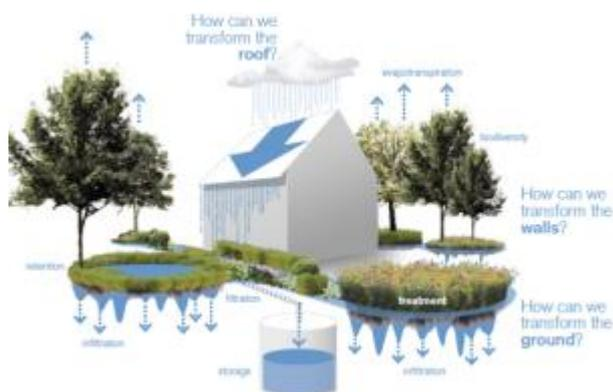
**Figura 29.** Tipologico elementi SuDS adottabili per singole abitazioni
