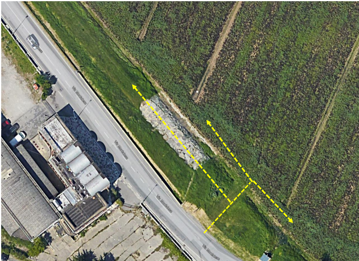
Figura 6 – Accesso dalla Via Montalese per la manutenzione di sinistra fossetta o per accedere allo sfioratore (in giallo i possibili percorsi di manutenzione)
