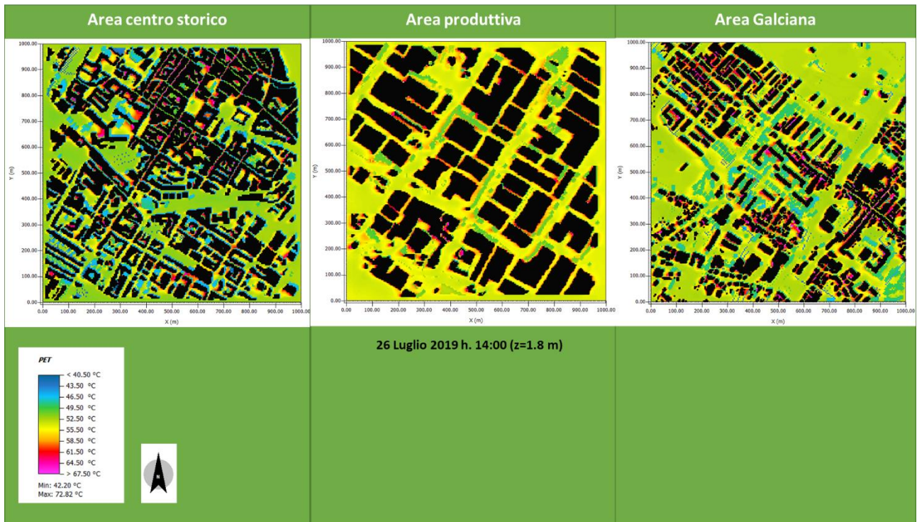
Figura 15. Temperatura fisiologica equivalente (PET) dell'aria a 1.8 m di altezza alle ore 14:00 simulata nelle tre aree inserite nel modello Envi-met.
