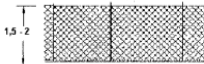
RECINZIONE IN PALI E RETE CON CORDOLO
