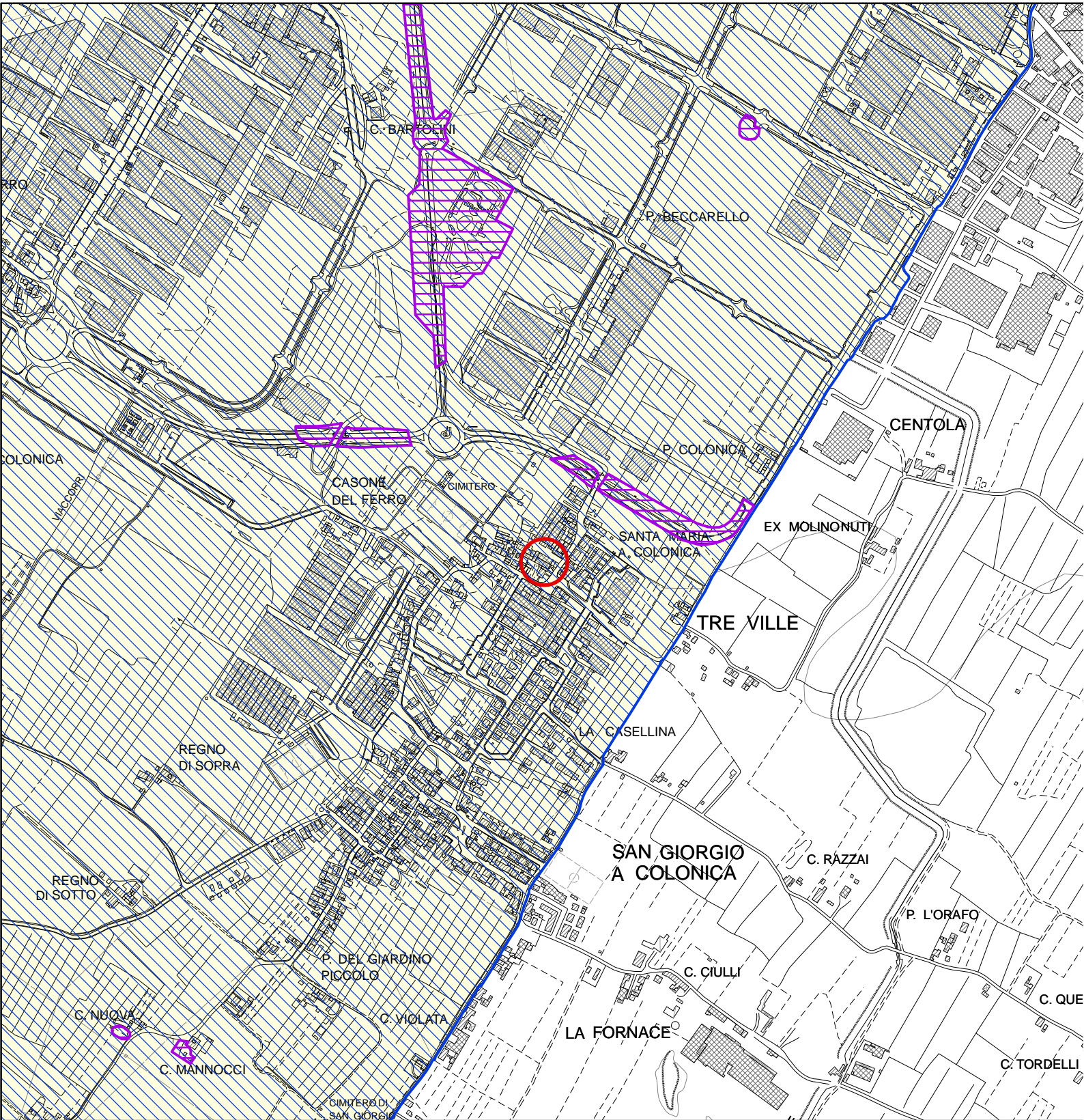
figura 8 - estratto della carta della pericolosità geomorfologica del P.S. scala 1:10.000
