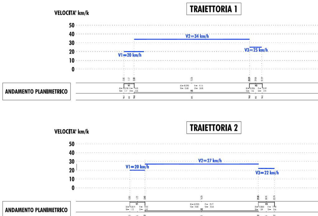
Figura 4-5 - velocità di progetto delle traiettorie 1 e 2
