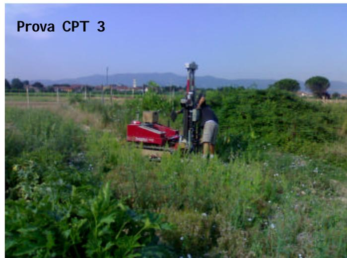
**PROVA PENETROMETRICA STATICA
