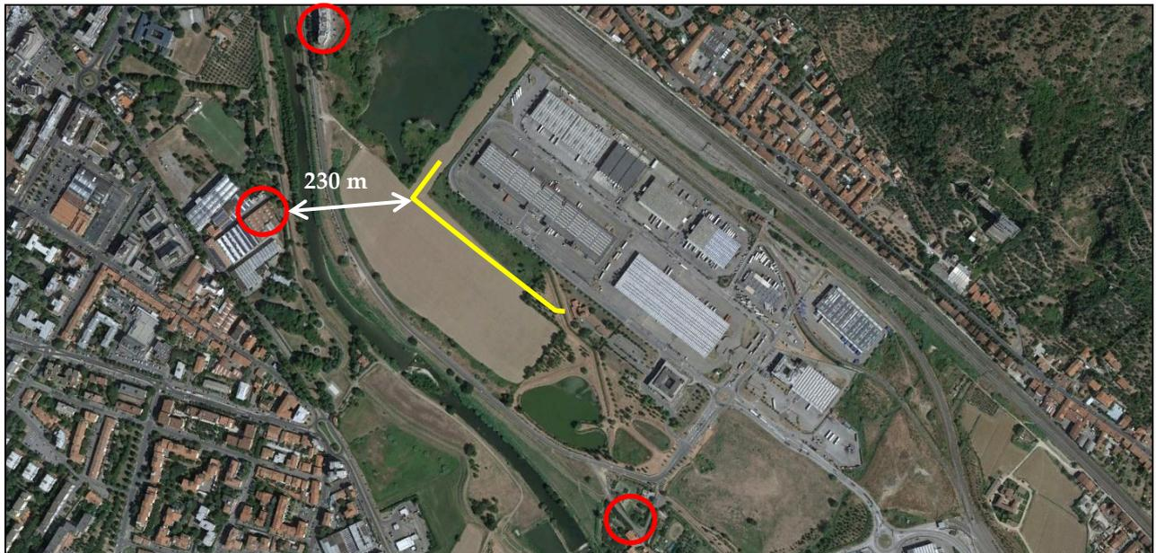
Figura 97. Scenario 1: area di lavorazione (in giallo) e identificazione dei ricettori potenzialmente più esposti
